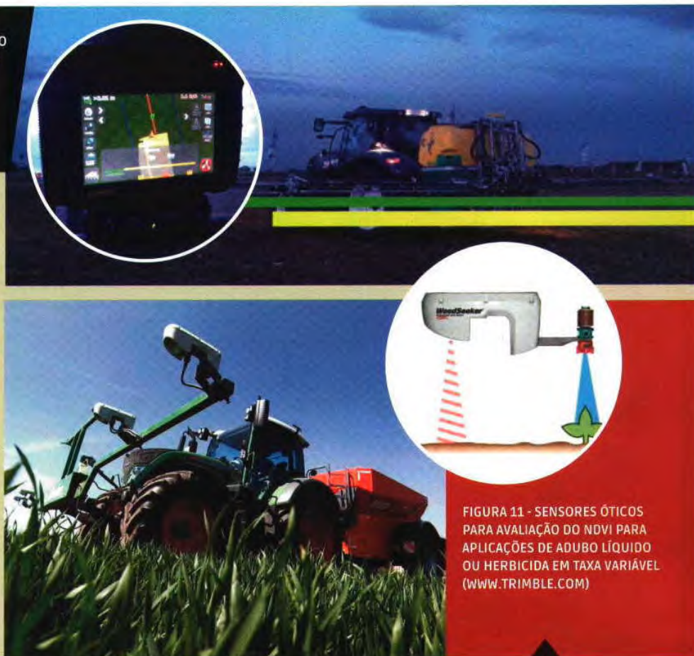
FIGURA 10 – TESTES DE UTILIZAÇÃO DE UM SISTEMA DE CONTROLO DE SECÇÕES NUM PULVERIZADOR TOMIX COM UM CONTROLADOR TRIMBLE/NEW HOLLAND.
