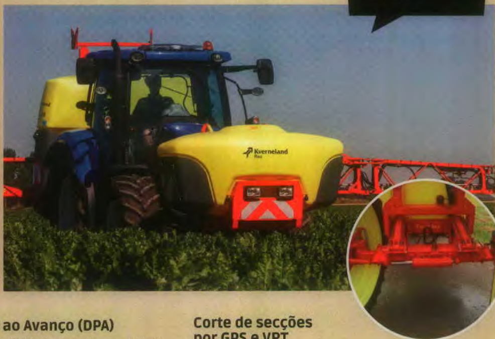
FIGURA 9 - DEPÓSITOS COMPACTOS E FRONTAIS PARA EQUILÍBRIO E AUTONOMIA DE TRABALHO PARA PULVERIZADORES MONTADOS E EIXO DIRECIONAL EM PULVERIZADORES SEMI REBOCADOS
